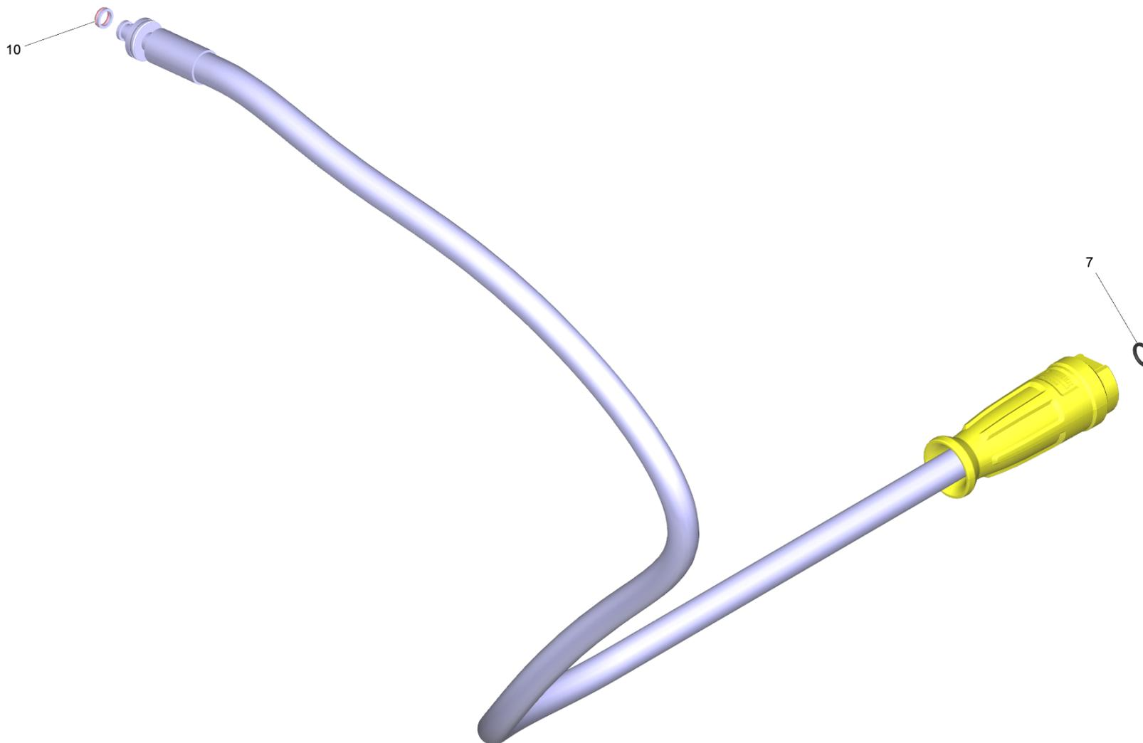
907 Schlauchleitung TR DN6 25MPa 15m (6.110-036.0)
