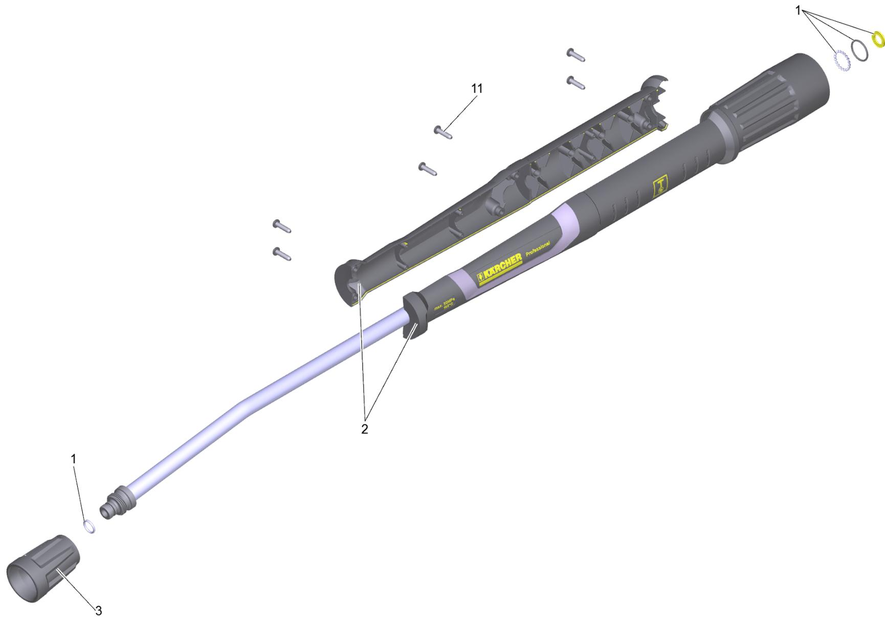
902 Strahlrohr TR 840 mm (4.112-006.0)
